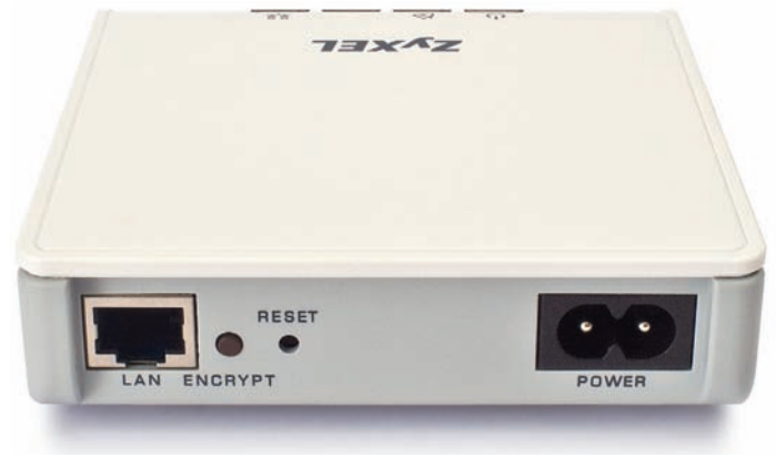
На задней панели адаптера ZyXEL PLA400 EE располагаются Ethernet- и HomePlug AV-порты, а также кнопки Reset и Encrypt
