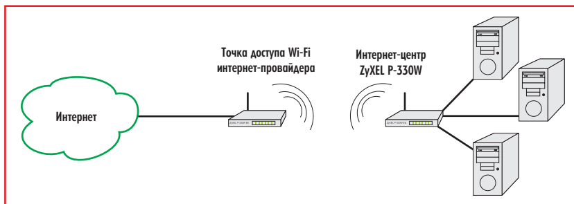
Рис. 5. Режим использования интернет-центра с подключением к провайдеру по Wi-Fi
